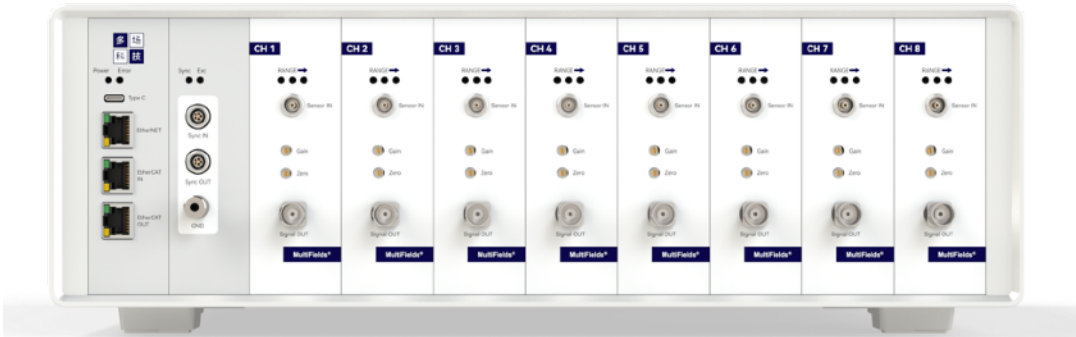
Figure 2. Faraday08，支持 8 通道同时测量
