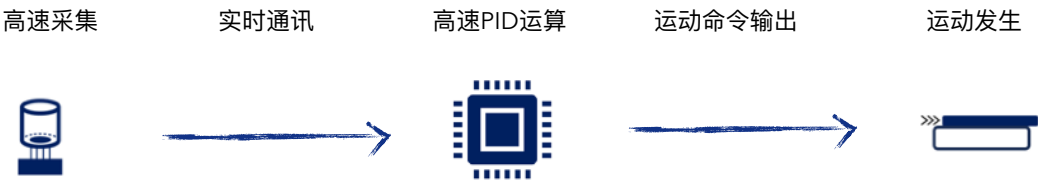
Figure 2. 运动闭环控制流程
