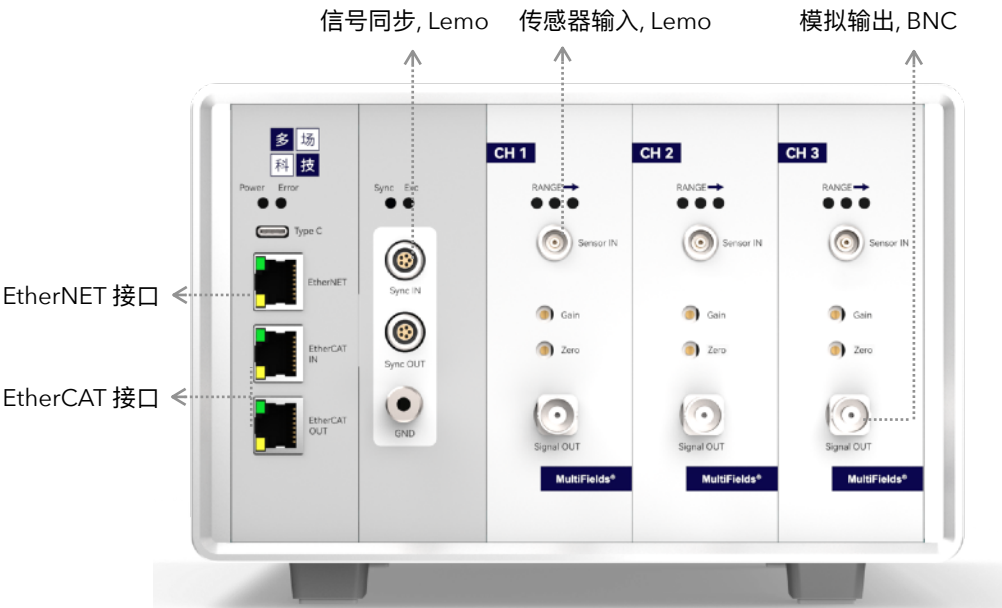
Figure 1. Faraday03，支持 3 通道同时测量
